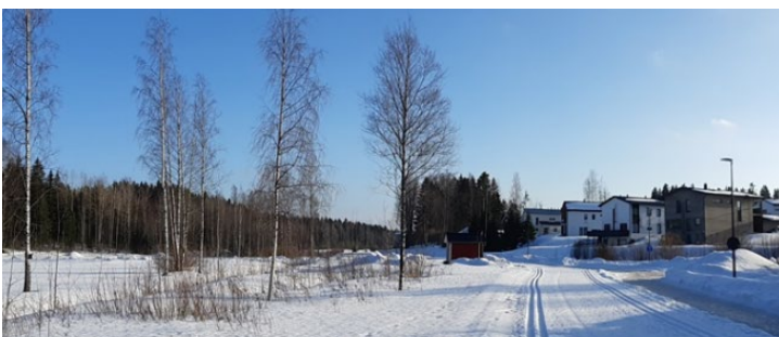
Bild 14 I det redan byggda området i Vårdalen har man anlagt en damm som jämnar ut vattenflödet intill utfalls- diket i dalsänkan. Bredvid diket finns en parkväg och skidspår på vintern.
