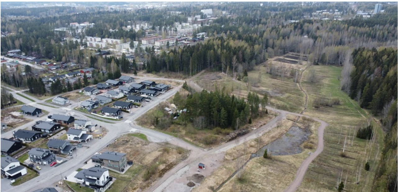
Kuva 1: Kopterikuva etelästä päin. Kevätlaaksoista on osa jo rakennettu ja osa vasta kaavoitettu. Laakson valtaojan varteen on muotoiltu hulevesitulvia tasaava lampi. Kevätlaaksonrinne sijoittuu laakson pohjoispäähän, joka näkyy kuvan oikeassa yläkulmassa sekametsänä.
