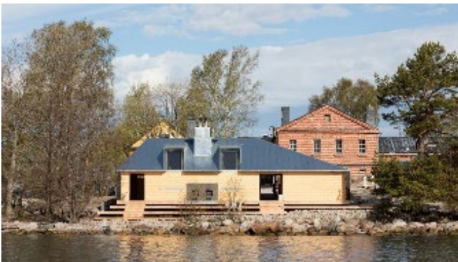
Kuva 16. Terassi- ja laiturirakenteet tulee porrastaa niin, ettei erillisiä kaiteita tarvita rannan suunnalle (kuvat: Lonna sauna / OPEEA ja Saunaravintola Kiulu / Studio Puisto).
